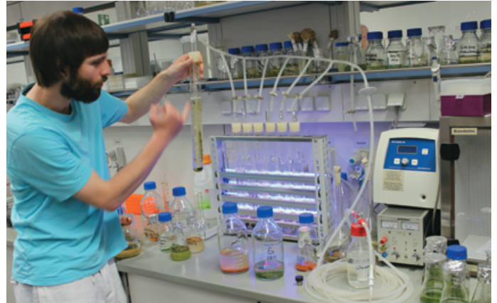
Auch biophysikalische Grundlagenforschung ist im HOT vertreten: Hier zeigt der Physiker Matthias Koch einen Bioreaktor zur Anzucht von Algen, welche bei wechselnden Lichtverhältnissen mit Resonanz-Ramanspektroskopie untersucht werden.
